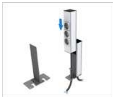
Przykład mocowania boksu pionowo do podłogi podniesionej (potrzebne wtedy specjalne uchwyty).
