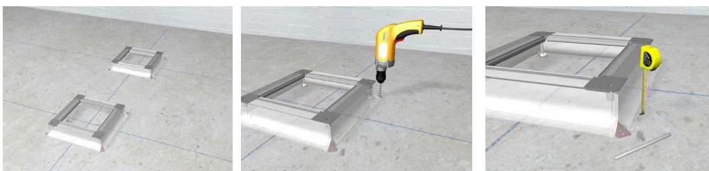
Widok kompletnej puszki UDH3 wraz z zamontowanymi kanałami podłogowymi.
