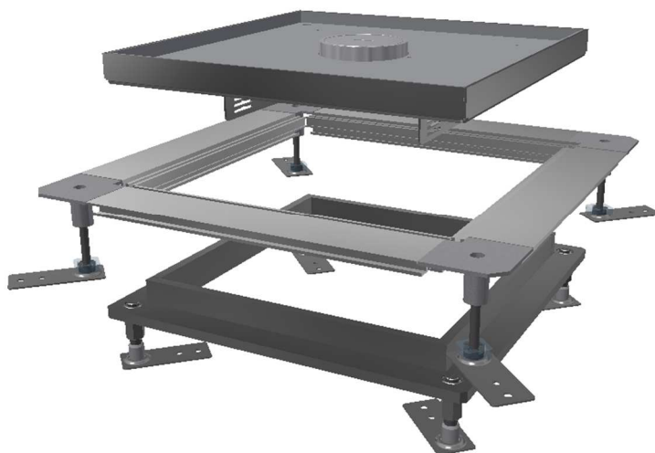
Poglądowy schemat montażowy kasety UFKK Q360. Ważna kolejność montażu ( od RSLK poczynając ).
