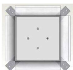
Widok z góry kasety z szalunkiem z folii. Folia wyłożona na zewnątrz.
