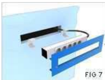
Montaż listwy w płycie GK
